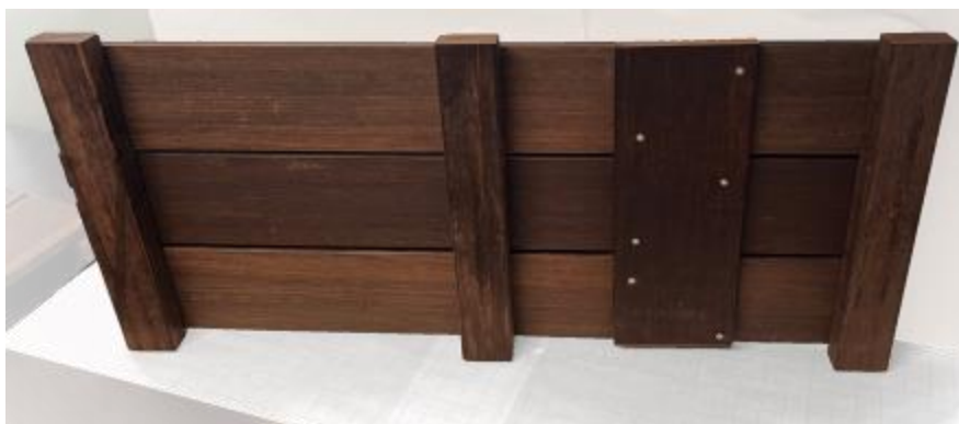
Figure 18 : Caillebotis pour accès aux relevés, vue du dessous
